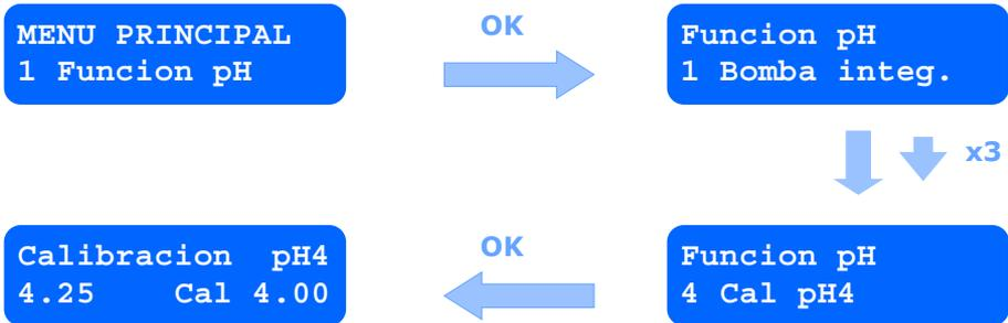
Al entrar en el submenú *4 Cal pH 4* y pulsar **OK**, encontrará la pantalla de la parte inferior izquierda de la figura. El valor de la izquierda muestra la lectura actual de la sonda de pH. El valor a la derecha de *Cal* indica el pH de la solución de calibración utilizada. Puede ajustar este valor mediante las flechas para adecuarlo a la temperatura y a la solución utilizada.
