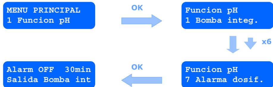
La alarma de tiempo de dosificación de pH permite disparar una alarma que detiene la dosificación si el tiempo transcurrido sin alcanzar el valor de consigna programado supera un cierto límite. Esto puede ser útil para prevenir excesos de dosificación, señalar la falta de producto en el bidón o para detectar posibles problemas en la sonda o en la inyección.
