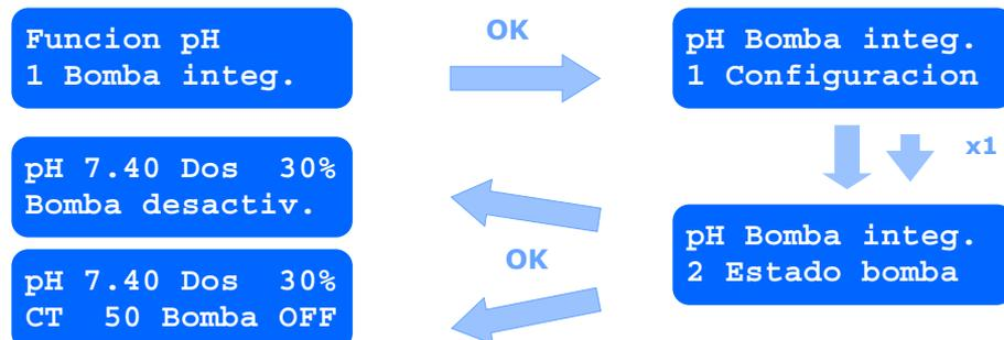
Esta pantalla muestra la medida de pH actual y el porcentaje de dosificación calculado. Si la bomba está desactivada la pantalla mostrará *Bomba desactiv.* Si la bomba está activada mostrará en la línea inferior el transcurso del ciclo de trabajo (CT) y el estado actual de la bomba (ON/ OFF). Tenga en cuenta que, si existe alguna causa (retardo activado, alarma de tiempo de dosificación), la bomba permanecerá en OFF aunque la dosificación no sea 0%.
