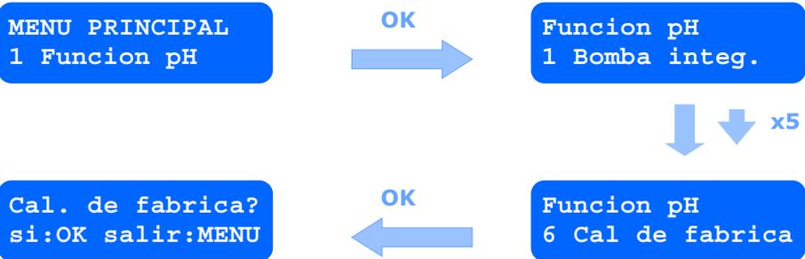
Use esta función para volver a establecer la calibración a la salida de fábrica que corresponde a la respuesta teórica de una sonda nueva. Esta función puede ser útil en algunas situaciones, para diagnóstico o bien si no dispone de soluciones de calibración. Pulse **OK** para restablecer la calibración de fabrica o **MENU** para salir.
