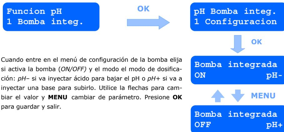
Cuando entre en el menú de configuración de la bomba elija si activa la bomba (*ON/OFF*) y el modo el modo de dosificación: *pH-* si va inyectar ácido para bajar el pH o *pH+* si va a inyectar una base para subirlo. Utilice la flechas para cambiar el valor y **MENU** cambiar de parámetro. Presione **OK** para guardar y salir.
