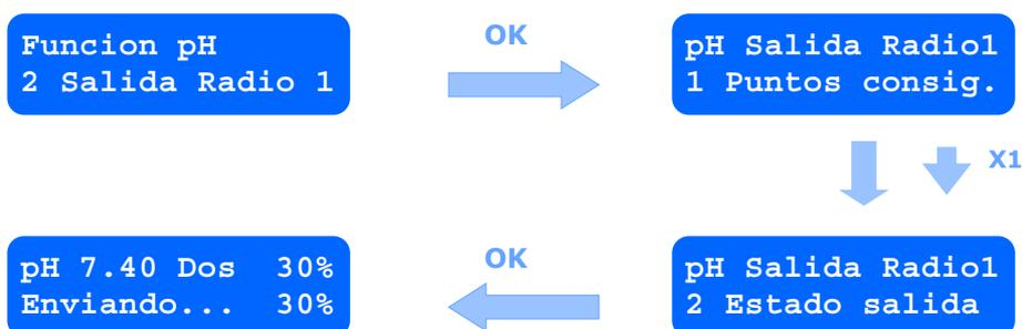
Esta pantalla muestra la medida de pH actual, el porcentaje de dosificación calculado y el comando de control que está siendo transmitido. Tenga en cuenta que si existe alguna causa (retardo activado, alarma de dosificación), el comando transmitido será 0% aunque la dosificación no sea 0%.
