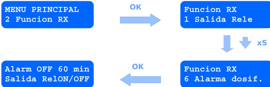
La alarma de tiempo de dosificación de RX permite disparar una alarma que detiene la producción o la dosificación de cloro si el tiempo transcurrido sin alcanzar el valor de consigna programado supera un cierto límite. Esto puede ser útil para prevenir excesos de dosificación, señalar la falta de producto en el bidón o para detectar posibles problemas en la sonda o en la inyección.
