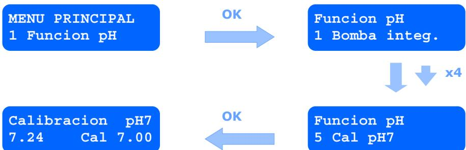
Retire la sonda de la solución a pH4, aclare su parte inferior con agua limpia y sacúdala suavemente para eliminar el exceso de agua (no frote la sonda con un paño o un papel). Vaya a continuación al menú *5 Cal pH7* y repita el proceso anterior con la solución a pH7.
