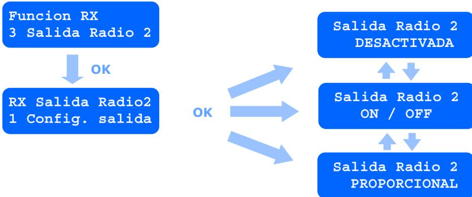
Cambie el modo pulsando las flechas. Pulse **OK** para seleccionar el modo y entrar en el menú de configuración correspondiente o bien pulse **MENU** para salir.
