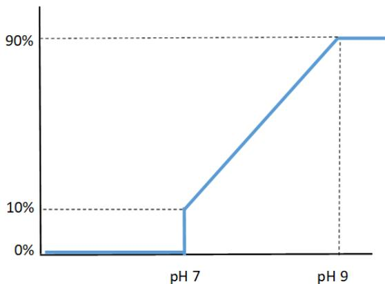
El cálculo de la dosificación se realiza seleccionando dos puntos de consigna como muestra la pantalla de la derecha. El cálculo de la dosificación (trazo azul) es el siguiente:
