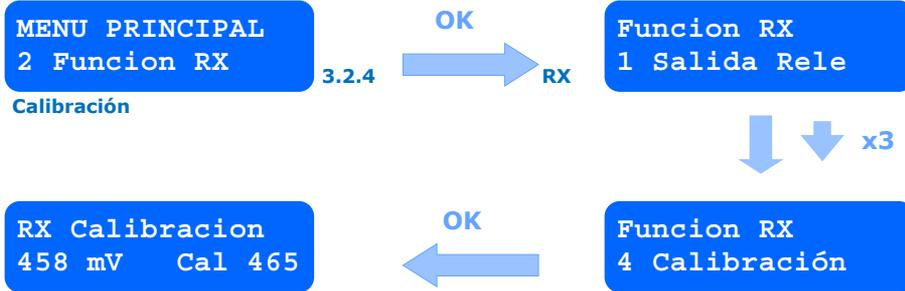
Al entrar en el submenú *4 Calibración* pulsando **OK**, encontrará la pantalla de la parte inferior izquierda. El valor de la izquierda muestra la lectura actual de la sonda. El valor de la derecha (*Cal*) indica el valor de la solución de calibración utilizada. Puede ajustar este valor mediante las flechas para adecuarlo a la temperatura y a la muestra utilizada.
