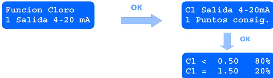
Las salidas analógicas 4-20 mA de dos hilos representan el porcentaje de dosificación en mA mediante una relación lineal:
