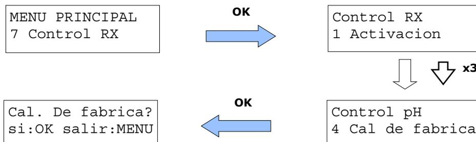
Mediante esta función puede volver a establecer la calibración de fábrica que corresponde, aproximadamente, con la medida teórica de una sonda nueva. Esta función puede ser útil en algunas situaciones para corregir o diagnosticar fallos o si no dispone de soluciones de calibración.
