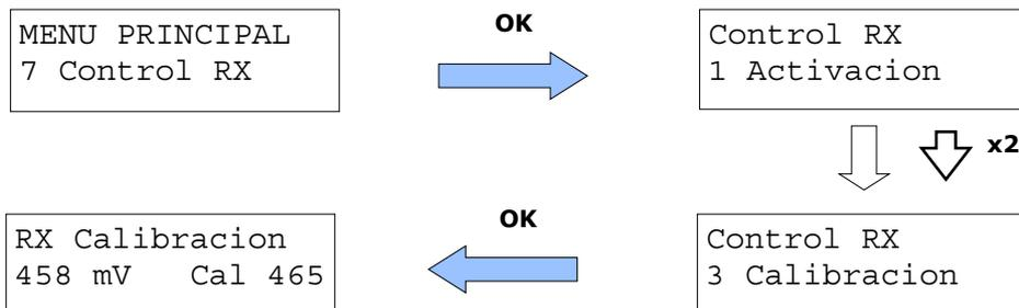
Al entrar en el submenú 3 *Calibración* pulsando **OK**, encontrará la pantalla de la parte inferior izquierda. El valor a la izquierda de la pantalla muestra el potencial redox medido por la sonda. El valor a la derecha de *Cal* indica el valor redox real de la muestra. Puede cambiar este valor con las flechas para ajustarlo a la solución de calibración que está utilizando. Tenga en cuenta que potencial redox de la solución depende de la temperatura como muestra su etiqueta.
